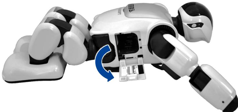
3. バッテリーパックを写真の向きにしてバッテリースロットに入れ、奥に差し込みます。
