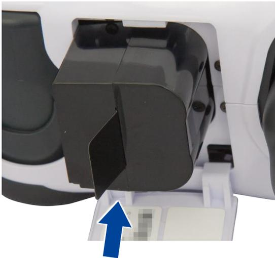
5. バッテリーパックの手前にバッテリーレバーが出て、バッテリーパックがしっかり固定されていることを確認してください。
