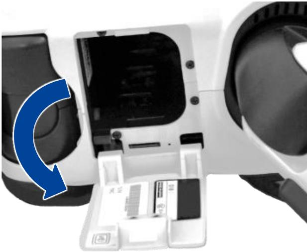
4. バッテリーパックを写真の向きにしてバッテリースロットにカチッと音がするまで入れ、奥に差し込みます。
